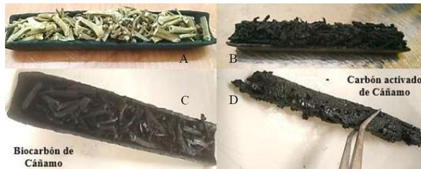
De acuerdo a la figura 1, se detalla que A) es el residuo de cáñamo; B) residuo de cáñamo activado con H<sub>3</sub>PO<sub>4</sub> al 85%; C) carbón activado sin activación química; D) carbón activado activado con H<sub>3</sub>PO<sub>4</sub> al 85%.
