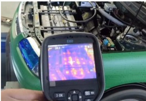
Figura 31 Identificación de puntos calientes durante el sistema de funcionamiento del VE.
