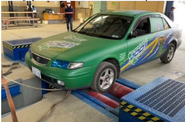
Figura 30 Montaje y anclaje del VE en el banco de pruebas dinámico
