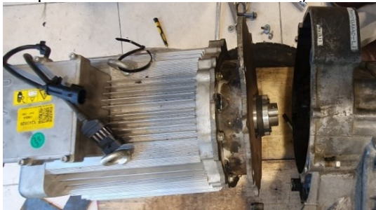
Acople del motor eléctrico con la caja de cambios mecánica
