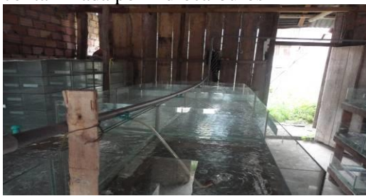
Figura 15 Tanques de biorremediación de agua contaminada por hidrocarburos
