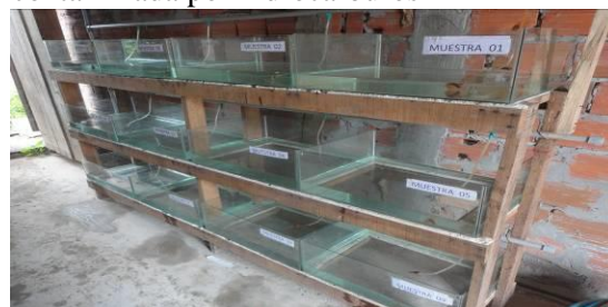
Figura 16 Tanques de biorremediación de agua contaminada por hidrocarburos
