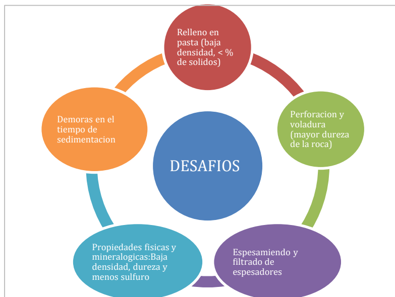
Diagrama N° 3: Diagrama circular de los desafíos que significo el ingreso de VM en la producción.
