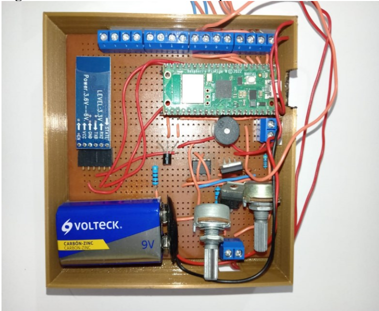
Figura 3: Circuito electrónico final que estará dentro del bolsillo central del chaleco
