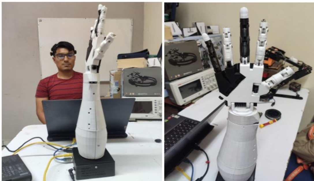
Figura 25. Brazo robótico manipulado con comando mental “neutral”.
