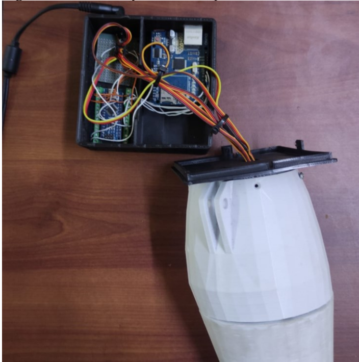
Figura 24. Cableado y conexiones para el brazo robótico.
