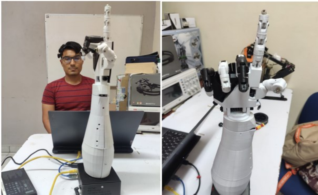
Figura 26. Brazo robótico manipulado con comando mental “right”.
