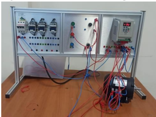
Figura 13. Tablero de control de pruebas de motores trifásicos
