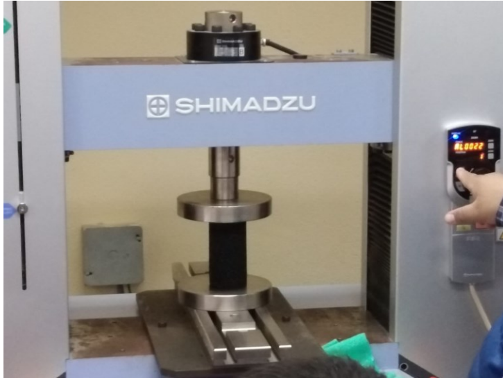
Figura 1. Realización de pruebas a compresión en Máquina de ensayos universales Shimadzu.
