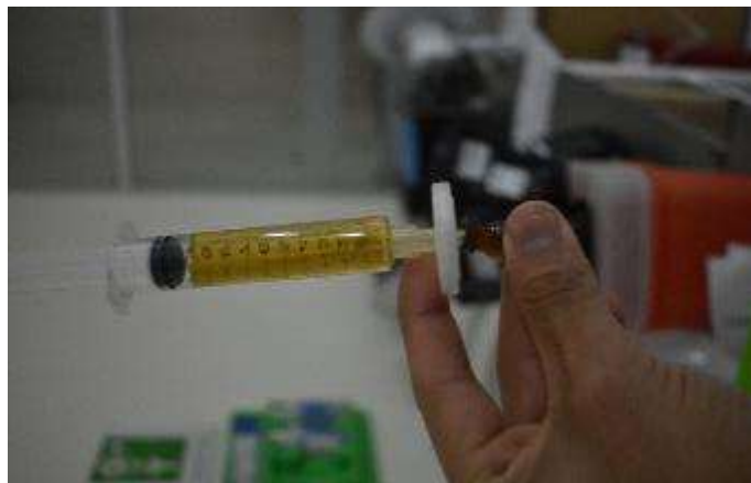
Figura 12. Filtración previa a inyección.
