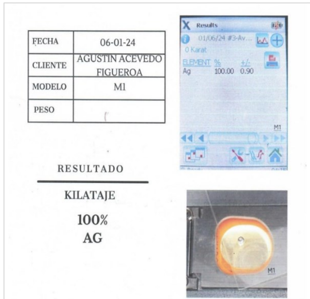
Imagen 1. Resultado de análisis de la muestra M1. 100% (plata) Ag.
