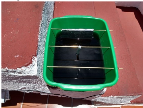
Imagen 5 celda electrolítica con electrodos de acero inoxidable y placa de aluminio.
